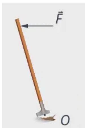
Рис. 8. Действие малой силы на черенок лопаты
