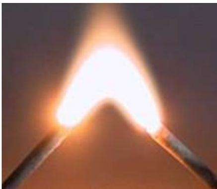
Рис. 6. Электрическая дуга
