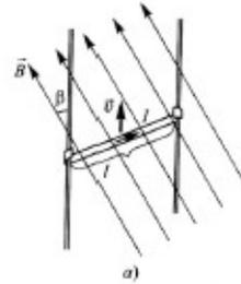
**Решение.** На проводник с током, помещённый в магнитное поле, действует сила Ампера  $F_A = IBl \sin \alpha$ . По условию задачи  $\alpha = \pi/2$ . Вектор силы Ампера перпендикулярен как проводнику, так и вектору магнитной индукции (рис. б). Движение проводника осуществляется в вертикальном направлении.
