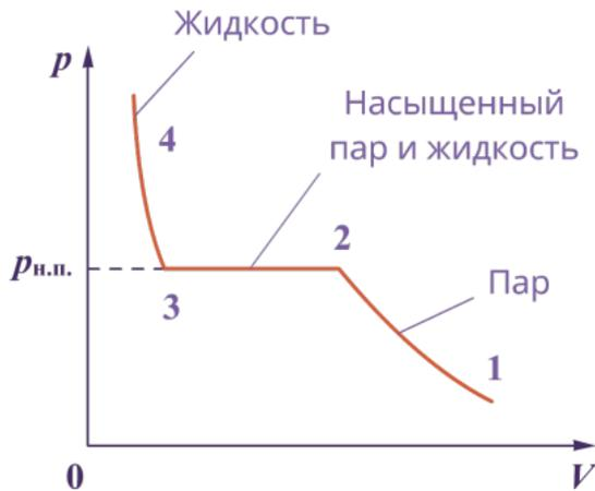
Газовые законы для насыщенного пара несправедливы. В то же время состояние насыщенного пара достаточно точно описывается уравнением Менделеева-Клапейрона.
